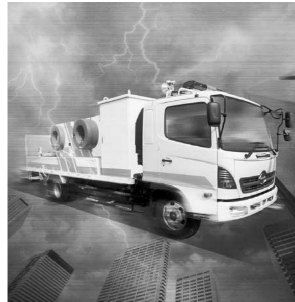
配備される大型排水ポンプ車
